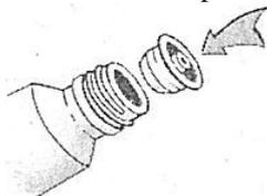
3. Adaptar a pipeta dosadora no adaptador de frasco;
